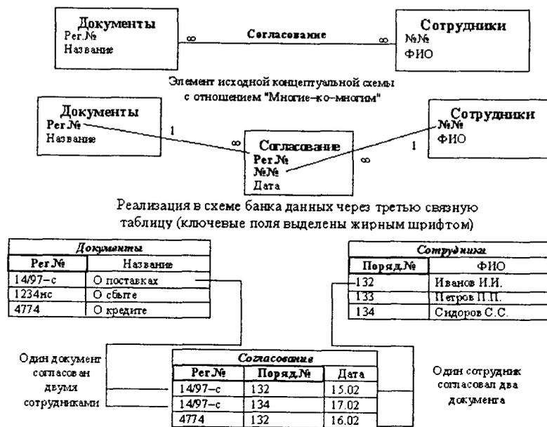
Рис. 3.3. Реализация связей «Многие-ко-многим» в реляционных СУБД
