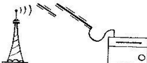
Изменение частоты в контуре производится изменением электроемкости переменного конденсатора (на место конденсатора — костыль!). При совпадении частот в антenne и в контуре наступает резонанс — то есть резкое усиление колебаний...
